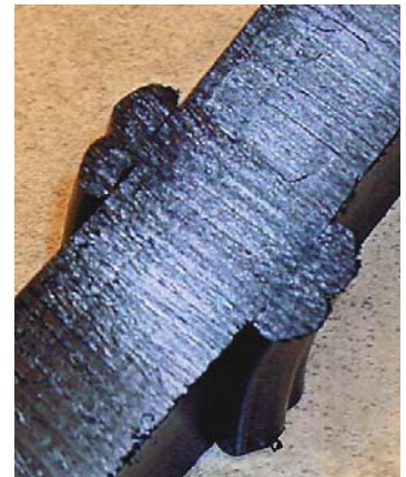
Hitsauspurseita PE putkessa, puskuhitaussuositoksen poikkileikkaus
