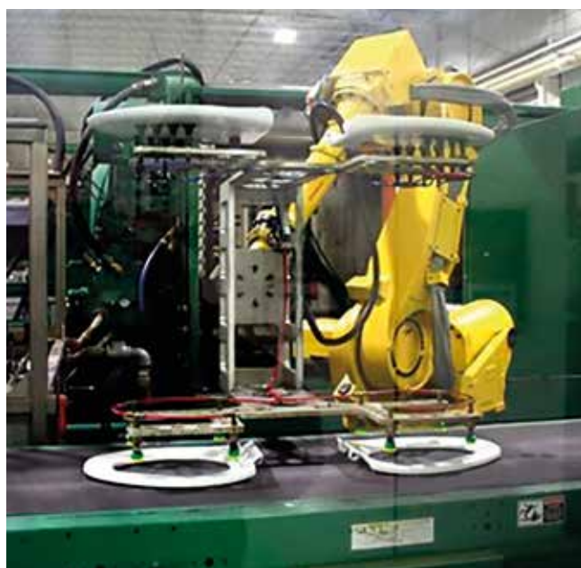
Alipainetarraimia ruiskuvälukkeen robotilla
