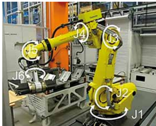
Kuva: Robotin pääakselit ja varret
