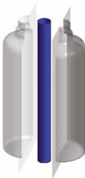
CAD malli suulakepuristetusta puhallusmuovausaihiosta
