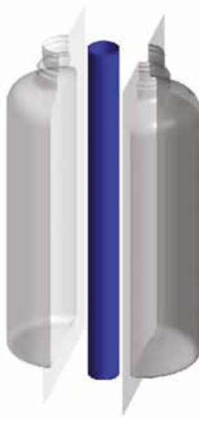
CAD malli suulakepuristetusta puhallusmuovausaihiosta
