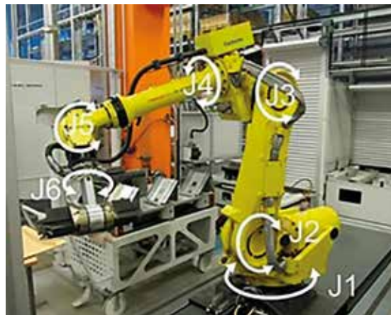
Kuva: Robotin pääakselit ja varret
